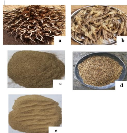
Figure 1: (a) Raw OPFW, (b) Dry OPFW, (c) pulverized OPFW, (d) Raw saw dust, (e) pulverized sawdust
